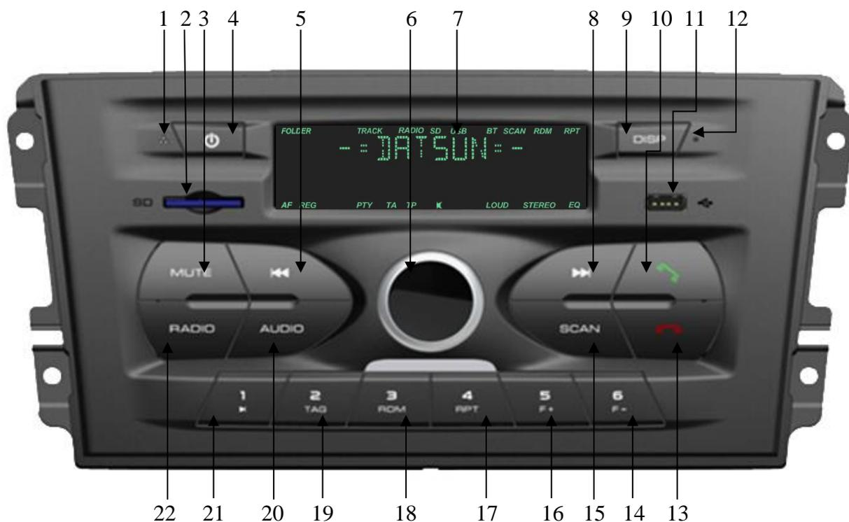
Рисунок 1 – Внешний вид и форма лицевой панели радиоприемника 2190-7900010-10
